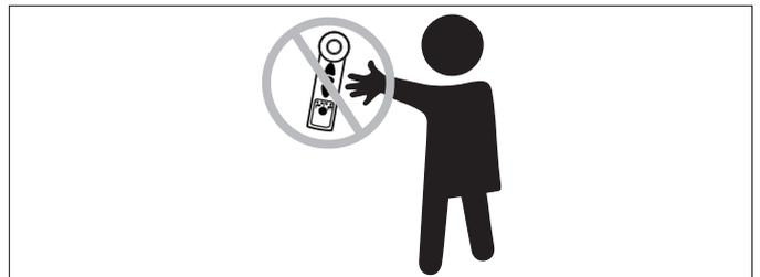
**!** Bei Arbeiten im Fahrbereich (z. B. Reinigungs- und Wartungsarbeiten) ist sicherzustellen, dass die Markise stromlos geschaltet ist (z. B. Sicherung ausschalten, Steckerkupplung am Motorkabel trennen, ...).
