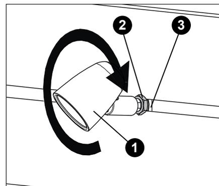
3. Den neuen LED-Spot (1) in die Schiene einsetzen und um 90° nach rechts drehen um den Klemmschlitten (3) in der Nut einzuhaken. Anschließend die Sechskantmutter (2) wieder festziehen.
