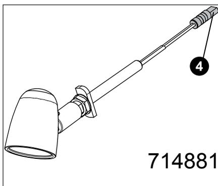
2. Den Stecker (4) des defekten Spots vom Stromnetz trennen und den neuen Spot einstecken.
