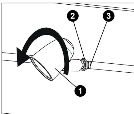
1. Mit einem Schraubenschlüssel SW 13 die Sechskantmutter (2) lösen. Danach den defekten LED-Spot (1) um 90° nach links drehen um den Klemmschlitten (3) in Laufrichtung der Nut zu bringen und herauszuziehen.
