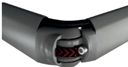
8 Bionic-Sehne und verdeckte Stromführung in den Armen
