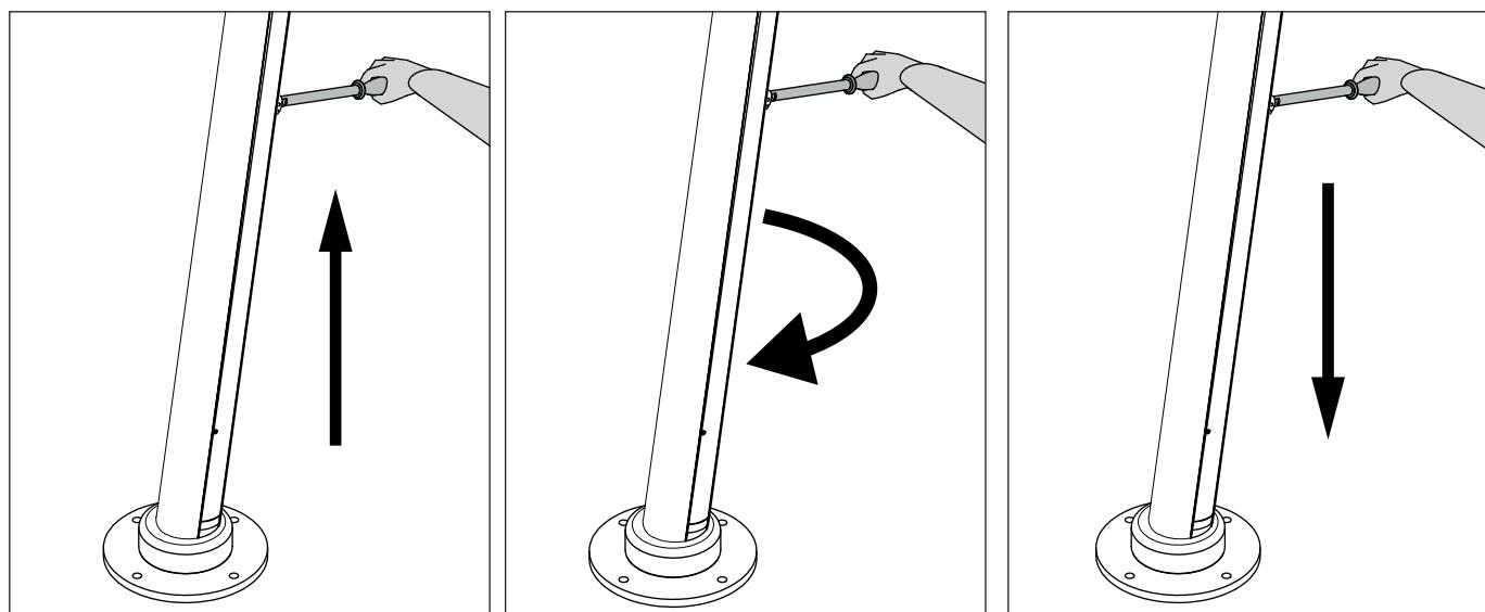
1. Den Griff anheben um die Verriegelung zu lösen.
