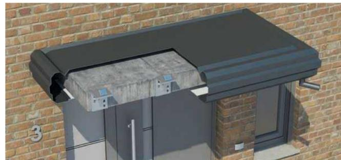
Wahlweise auch Stulpkonstruktion z. B. Vordachtyp KV 360. Hier wird die Wandanschlussblende in entsprechender Größe des vorhandenen Betonvordaches ausgeschnitten und das Vordach übergeschoben.
