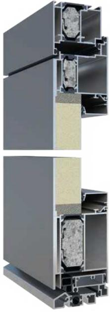
Die KO 80 HD ist ein universelles Profilsystem, das nach innen oder außen öffnend erhältlich ist. Es sind die Füllungsvarianten eingesetzt, außen flügelüberdeckend und beidseitig flügelüberdeckend möglich. Isopor-Dämmkerne zwischen den Profilkammern und drei Dichtungsebenen sorgen für gute Wärmedämmwerte. Rund- und Stichbogenkonstruktionen sind möglich.
