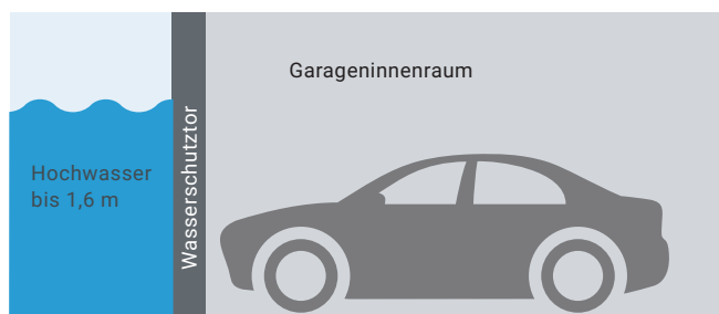
Das Wasserschutz Tor hält Starkregen oder Hochwasser bis zu einer Höhe von 1,6 m ab.
